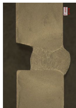
Spessore lamiera 10 mm, smusso su un lato 15 gradi, fessura 4 mm
