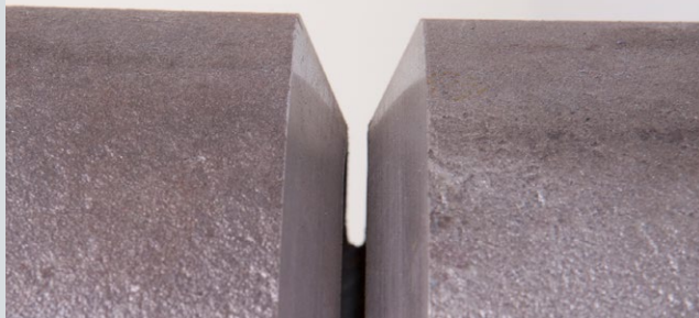
Preparazione del cordone di una saldatura di prima passata su tubo, angolo di apertura della saldatura di 60° con 3 mm di passata
