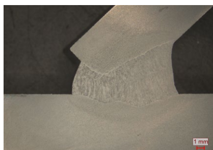
Spessore lamiera di rinforzo 10 mm, angolo di apertura della saldatura 35°
