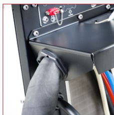
Scarico della trazione per pacco cavi di collegamento
